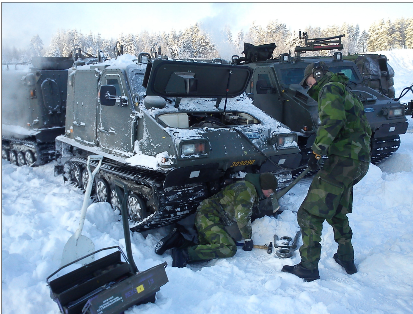
Haveri på drivaxeln på bandvagnen som bataljonen använde sig av. Termometern visade -25
