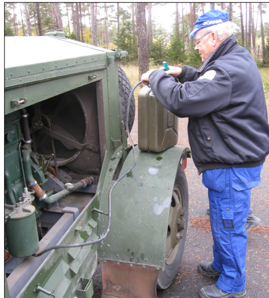
Bertil kopplar bensinen direkt till motorn, slang för ändamålet fanns behandlad på en kp-bil i förrådet.
