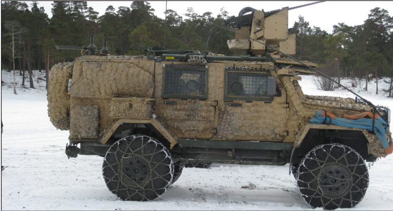
Galten har bästa sikten. Skytten sitter i fordonet och avger eld via sin datorskärm. Vapnet är en tung kulspruta 12,7 mm. Två förbereder sig Anders Grundberg, Emil Falk och Robin Larsson inför strid.
